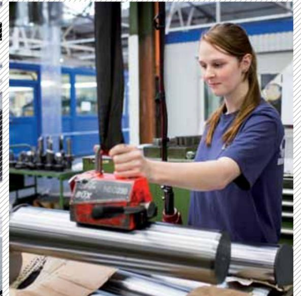
**M**it geübten Handgriffen und viel Gefühl steuert Lina Walkowiak den 38 Kilo schweren Stahlbolzen zur Drehmaschine. Die Werkzeuge hat die angehende Zerspanungsmechanikerin schon eingebaut. „Der Bolzen ist für das Gelenk eines Greifers bestimmt, dafür müssen der Spannansatz und die Gewinde weggedreht werden“, erklärt die 20-jährige. Auf Knopfdruck beginnt der Revolver zu rotieren, das Metall wird bearbeitet.
